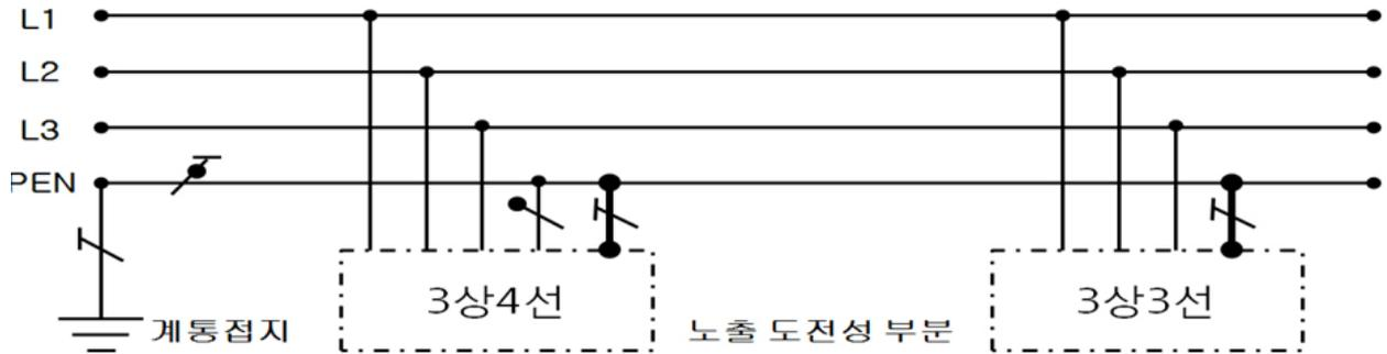
그림 1. 접지모델 (IEC 60364-5-54, IEC 1000-2-5, IEC 1024)
