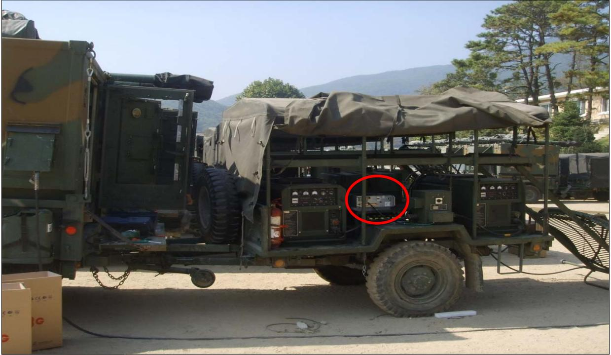
그림 13. 지원차량(발전기)에 3세대 접지장치(eca3G) LM Series 설치(2008.10)
